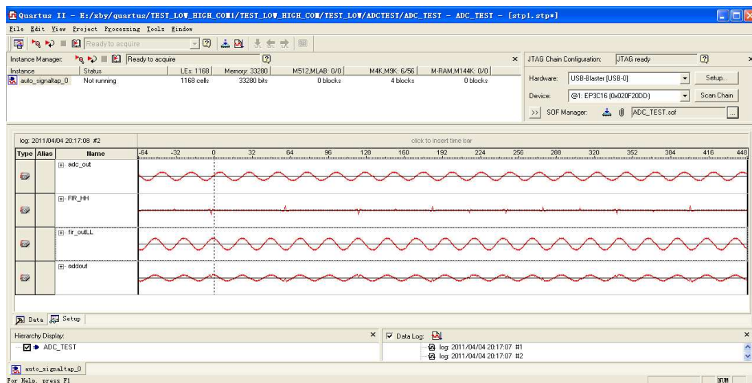
图 5-3-2 (1) 开启低通滤波器时域波形结果
