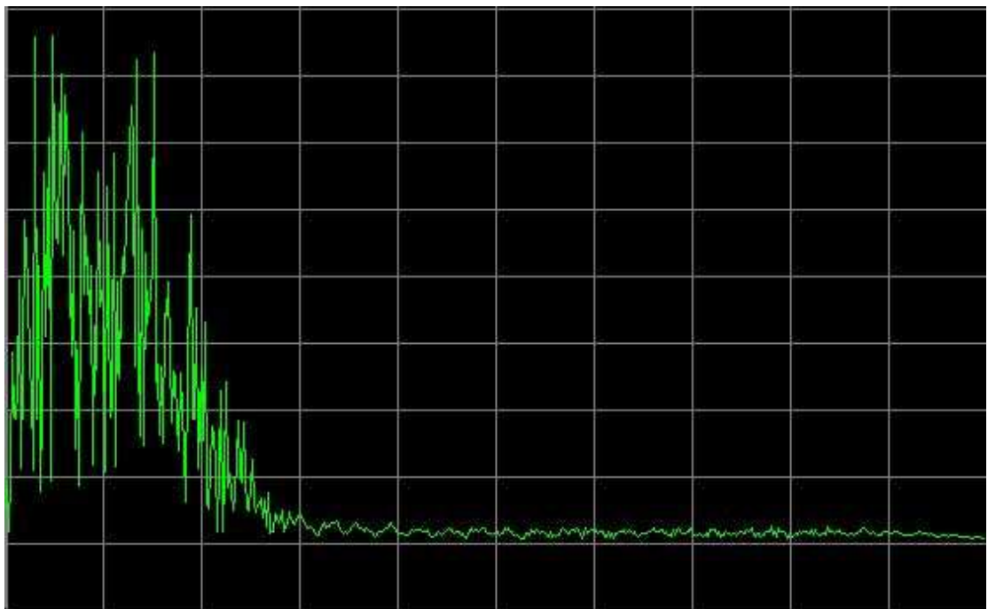
图 5-3-3 (2) 仅开启低通滤波器后白噪频谱 (横坐标每格 2205Hz, 纵坐标每格 100mV)
