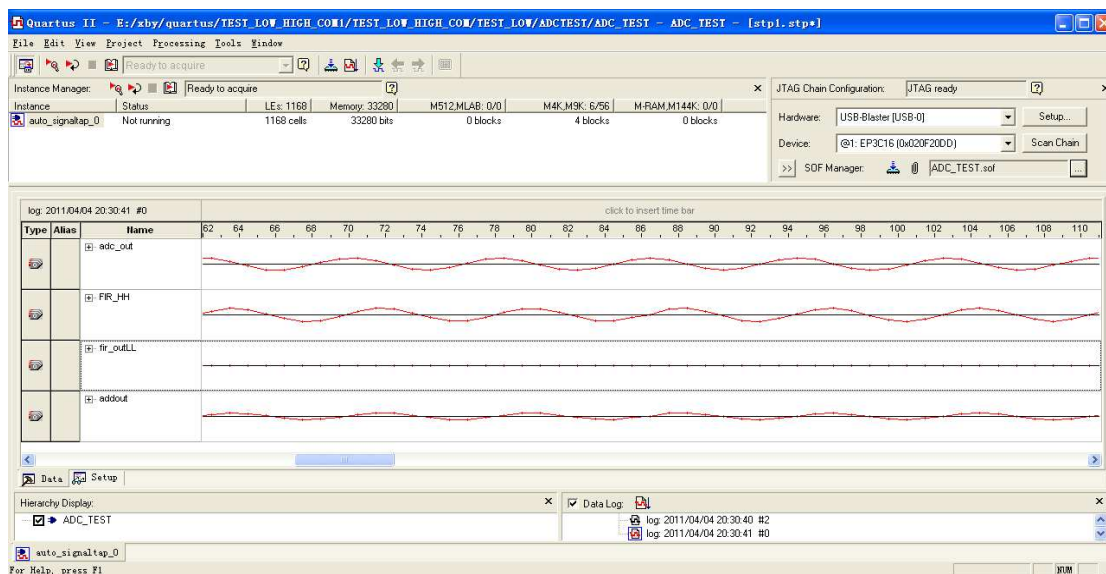
图 5-3-2 (2) 开启高通滤波器时域波形结果
